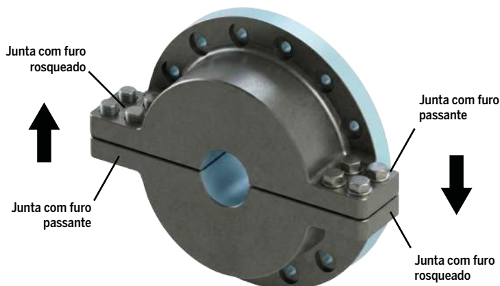
Figura 8: SENTIDO DE FIXAÇÃO DOS PARAFUSOS NO CUBO.
